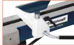
Spindel mit ASR-Abfallsicherung
